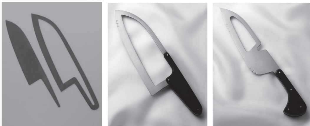
図16 左：三徳包丁のプレス打ち抜き材, 中央：座位姿勢包丁, 右：片手使用包丁 7-9) (D：森一枝)
