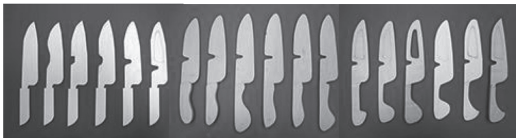
図14 片手使用包丁の木型試作：左の試作から右の試作へと検証した(制作：森一枝)
