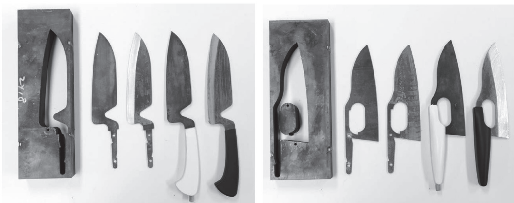
図 20 製作工程: 左から①ワイヤーカッター加工の端材, ②切抜き加工材, ③熱処理後のブレイド, ④グリップマスターモデル, ⑤右端が完成品
