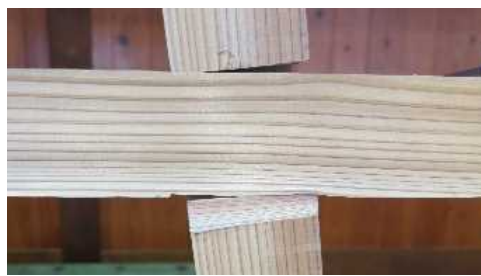
図 5 面格子壁の一部を取り出した実験
