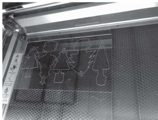
図9 レーザーカッターでアクリルを加工
