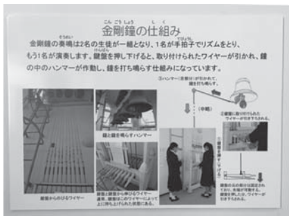
【図8】「金剛鐘の仕組み」の解説パネル
