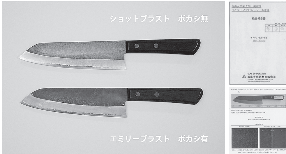
図4 Ti/白2/Tiで制作した試作包丁
