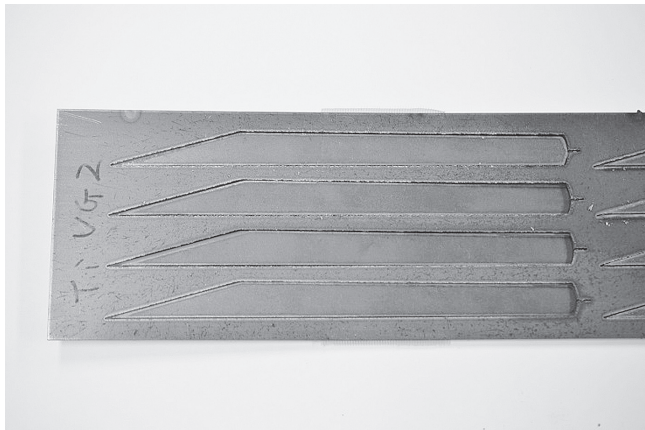
図7 レーザー加工機による切抜き加工
