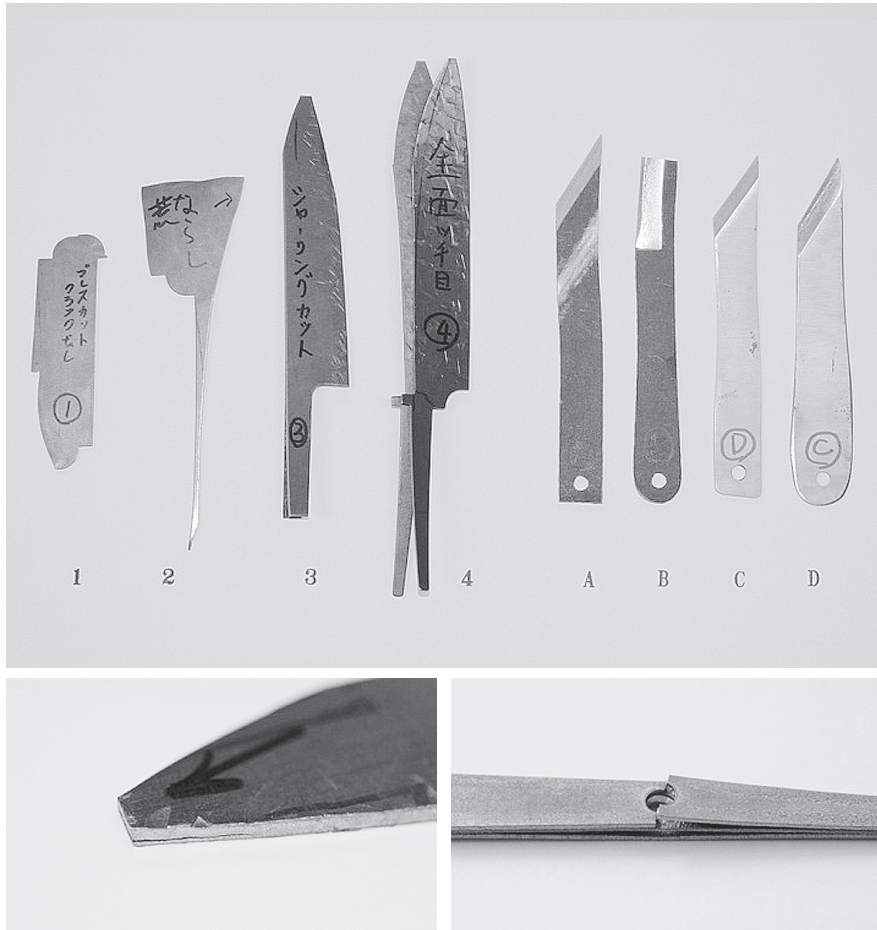
図6 焼入れ後に層間剥離が表れた箇所
