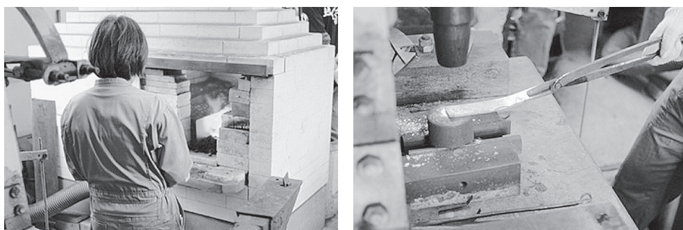
図2 伝統技法の「火造り鍛造」
