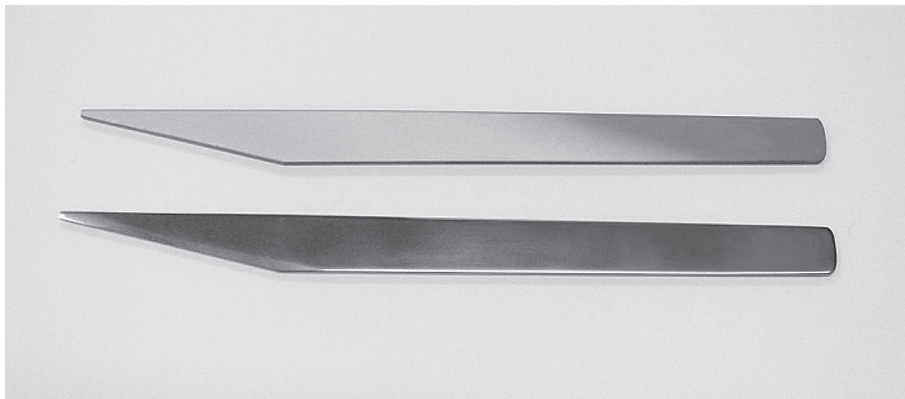
図10 上：サンドブラスト下地処理，下：研磨下地処理
