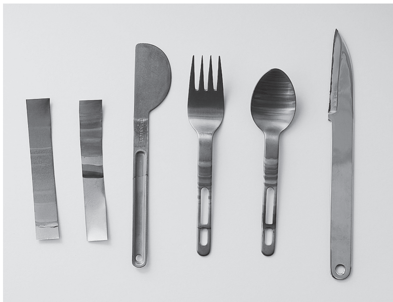
図8 チタン試験片および市販品での陽極酸化法の基礎実験
